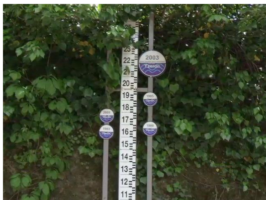
Repères de crues au quartier Ruette Mulet à Francheville
